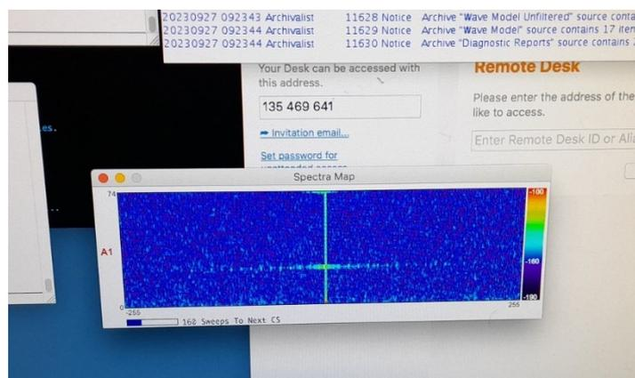
**Fig.1. Dettaglio della schermata del software SeaSonde in cui è illustrata l'assenza del segnale da uno dei loop di antenna (A1).**
