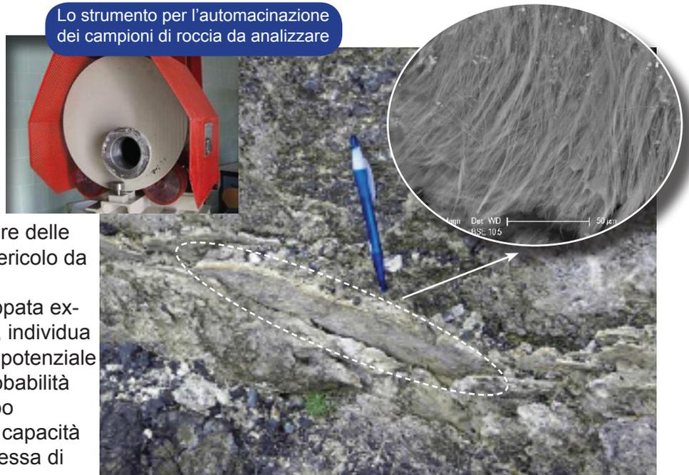
Brecce serpentinitiche campionate in località Casal di Pari, e immagine al microscopio elettronico a scansione (SEM) del campione prelevato
