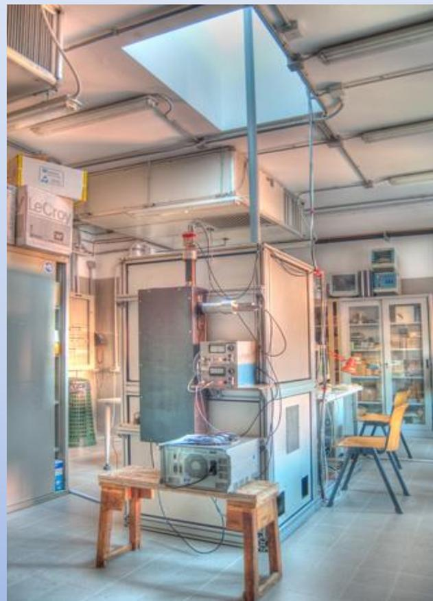
*L'attività LIDAR atmosferico inizia nel 1987, orientata allo studio dell'aerosol vulcanico in stratosfera e dei fenomeni legati al «buco dell'ozono». Dal 2001 in poi un mini-lidar interamente sviluppato al CNR (IROE/IFAC/INO) è utilizzato, in diverse versioni, per il monitoraggio continuo di nubi e polveri della bassa troposfera, tra 30 e 14000 m a.g.*
