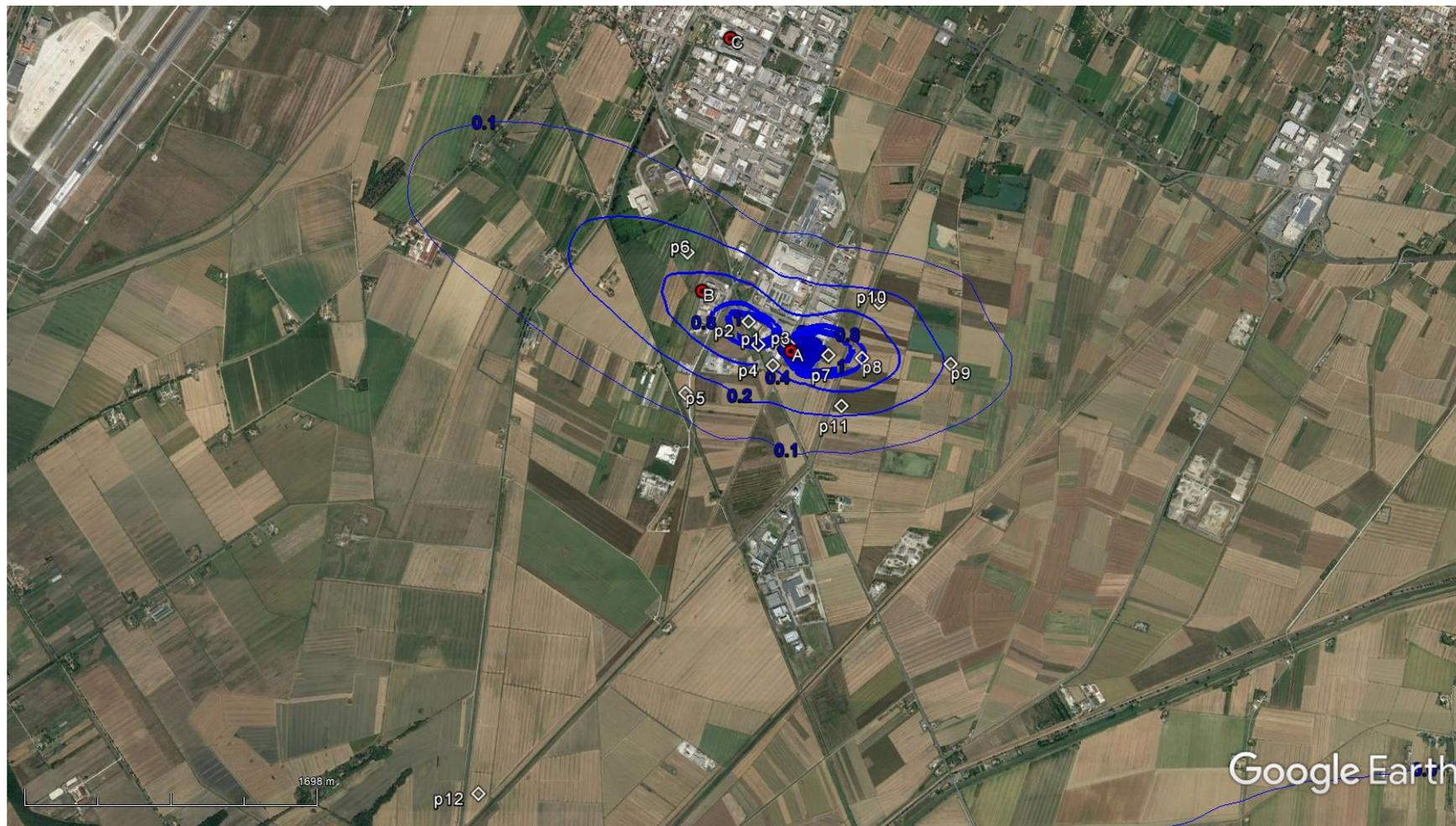
Mediante un modello è stata stimata, nelle condizioni di esercizio, la deposizione al suolo di diossine e furani (in ng TEQ/m<sup>2</sup>) emesse da due stabilimenti ed un impianto, al fine di orientare la scelta dei punti in cui prelevare terreni ed effettuare determinazioni analitiche (attività conclusa, in corso di pubblicazione).
